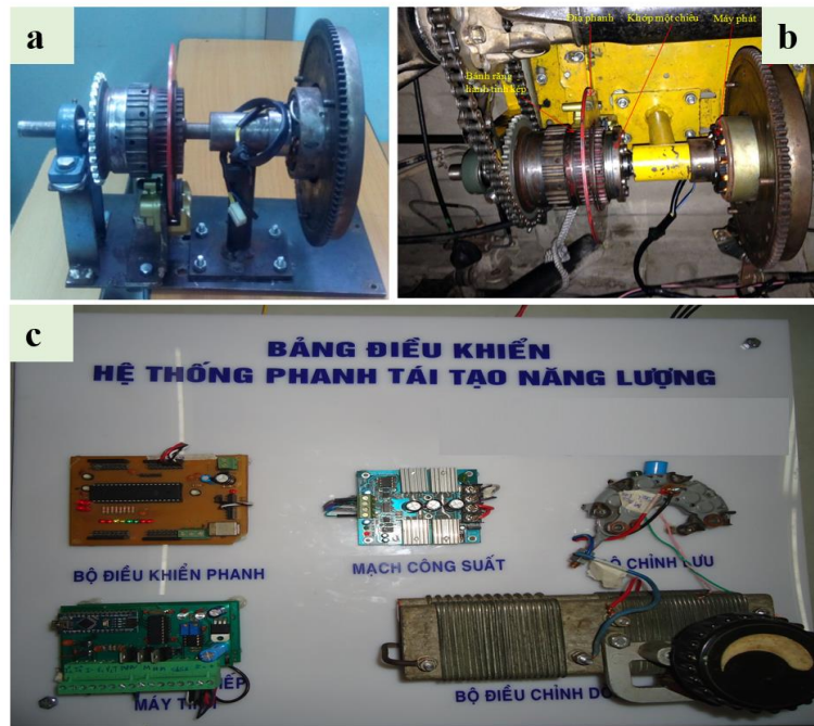
Hình 4.3: Các bộ phận của hệ thống phanh tái tạo năng lượng được lắp trên xe
