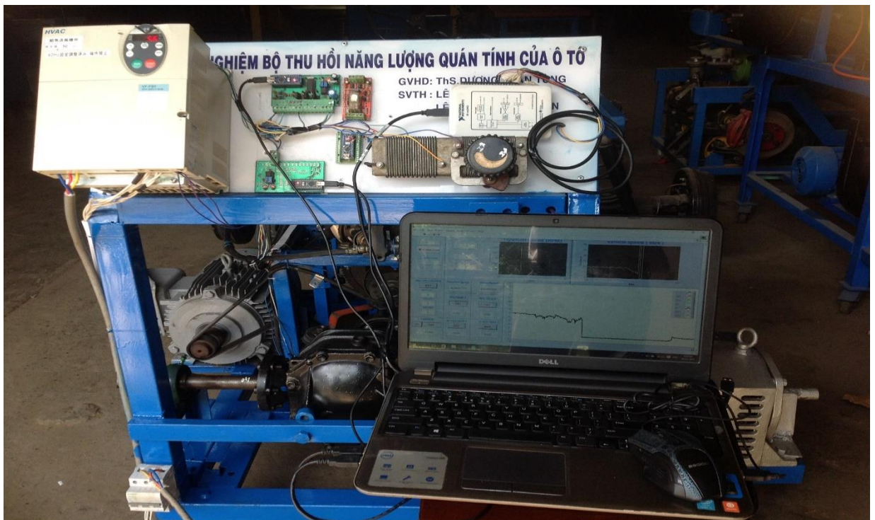
Hình 4.11: Thực nghiệm thu thập dữ liệu trên băng thử
