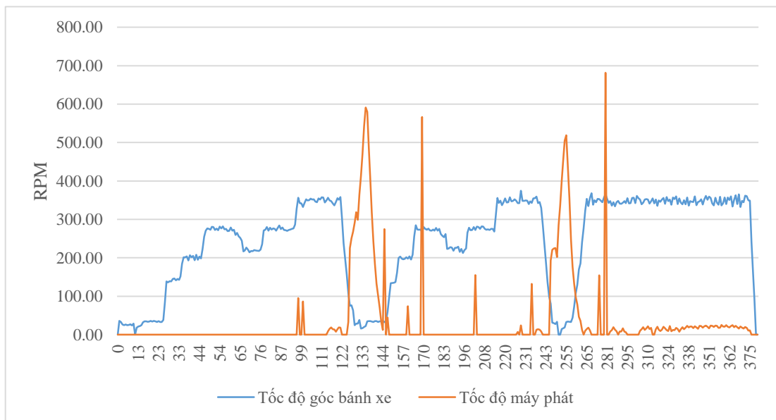
Hình 4.19: Biểu đồ cho thấy hệ thống kích hoạt khi tốc độ xe giảm
