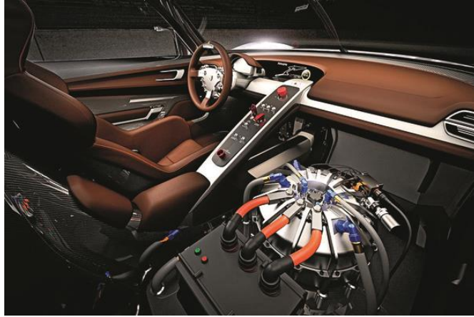
Hình 1.7: Bánh đà tích điện trên xe Porches 918 RSR concept [9]
